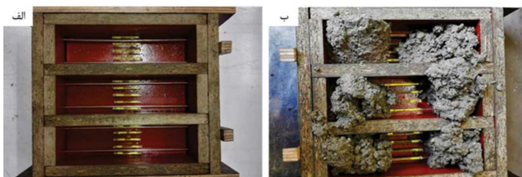
شکل ۷. کپسول‌های حاوی ماده ترمیم کننده در بتن (الف) قبل از بتن ریزی (ب) حین بتن ریزی (Van Mullem et al., ۲۰۲۰)
