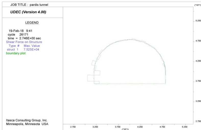
شکل ۱۸. نیروی برشی ایجادشده در لاینینگ با ضخامت ۵۰ سانتی‌متر
