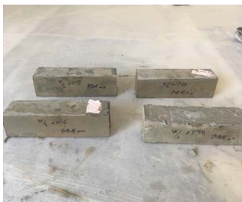
شکل ۶. نمونه‌های خمیر سیمان برای تعیین مقاومت خمشی
