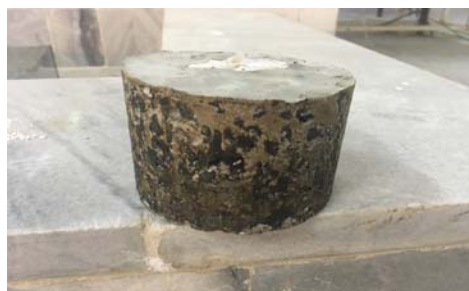
شکل ۱۶. نمونه روسازی نیمه‌صلب ساخته شده در آزمایشگاه
