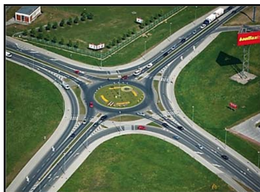
شکل ۲۳. میدان با چهار خط گردش به راست مجزا از نوع خط شتاب. شهر واراژدین-کرواسی [Tollazzi, 2015]
