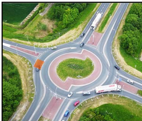
شکل ۲۵. نمونه طرح میدان توربوی اجرا شده [NCHRP Report 672, 2010]
