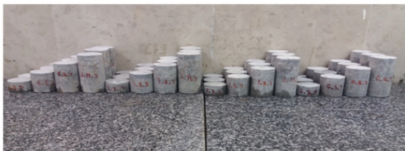
شکل ۵. قالب نمونه‌های بتنی با ارتفاع‌های مختلف ۱۱، ۸، ۵/۵ و ۳
