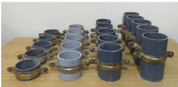
شکل ۵. قالب نمونه‌های بتنی با ارتفاع‌های مختلف ۱۱، ۸، ۵/۵ و ۳
