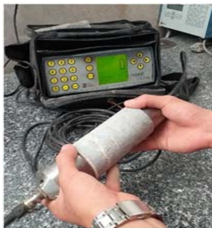
شکل ۹. دستگاه اندازه‌گیری سرعت موج فشاری
