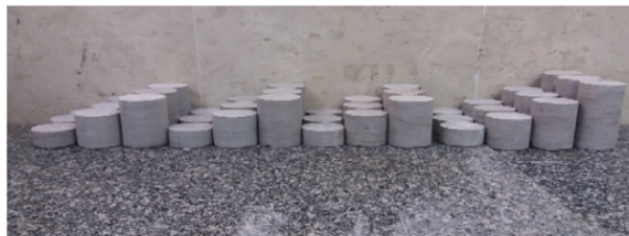
شکل ۵. قالب نمونه‌های بتنی با ارتفاع‌های مختلف ۱۱، ۸، ۵/۵ و ۳
