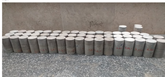
شکل ۶. نمونه‌های الف: بتنی، ب: سنگی و ج: کامپوزیت
