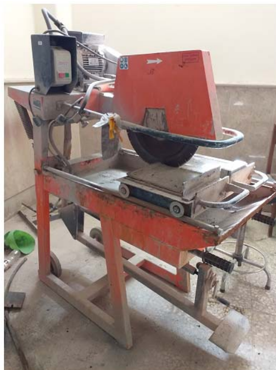
شکل ۷. دستگاه برای برش مفره‌ها
