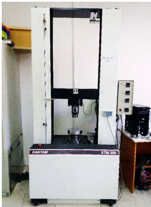
شکل ۸. دستگاه آزمایش مقاومت فشاری تک محوری
