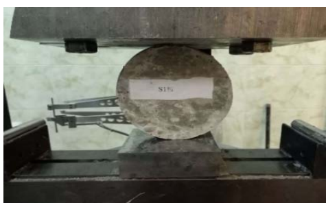
شکل ۲. آزمایش تعیین مقاومت کششی
