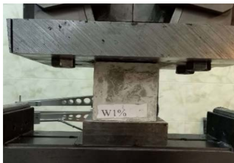
شکل ۳. آزمایش تعیین مقاومت فشاری
