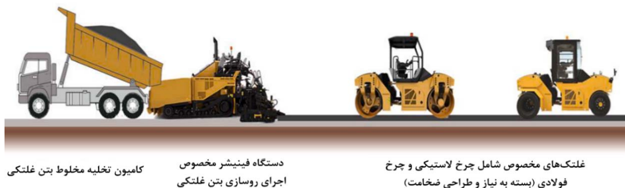
شکل ۱. ماشین آلات و تجهیزات مورد استفاده جهت اجرای روسازی بتن غلتکی (Ameri, Kamboozia & Khakbaz, 2023)
