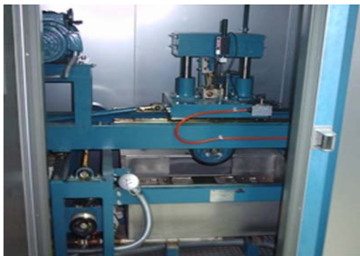
شکل ۲. دستگاه اندازه‌گیری عمق شیار ویل تراک (Fakhri & Towfigh, 2002)
