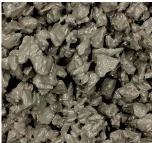
شکل ۳. بتن تازه نفوذ پذیر با حجم مناسب خمیر سیمان جهت پوشش سنگدانه‌های درشت (AlShareedah & Nassiri, 2021)
