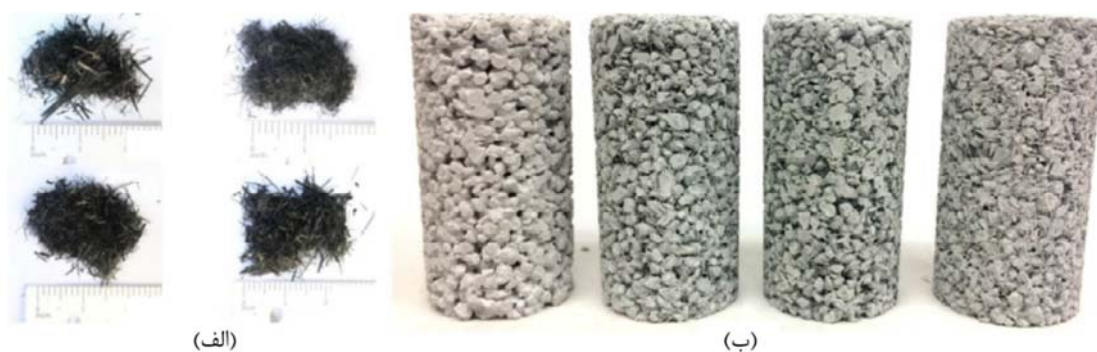
شکل ۵. الیاف‌های بازیافتی حاصل از کامپوزیت‌های فیبر کربن (الف) در ابعاد مختلف و (ب) در نمونه‌های بتن نفوذ پذیر (Rodin et al., 2018)
