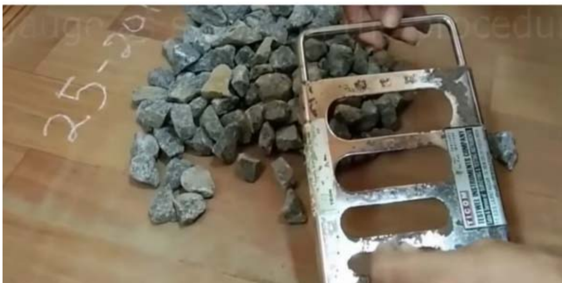
شکل ۳. تعیین درصد وزنی سنگ دانه‌های پولکی با استفاده از صفحه شیاردار
