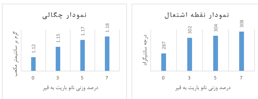
شکل ۱۱. تغییرات نقطه اشتعال در مقابل میزان نانو باریت (راست) و تغییرات وزن مخصوص در مقابل میزان نانو باریت (چپ)
