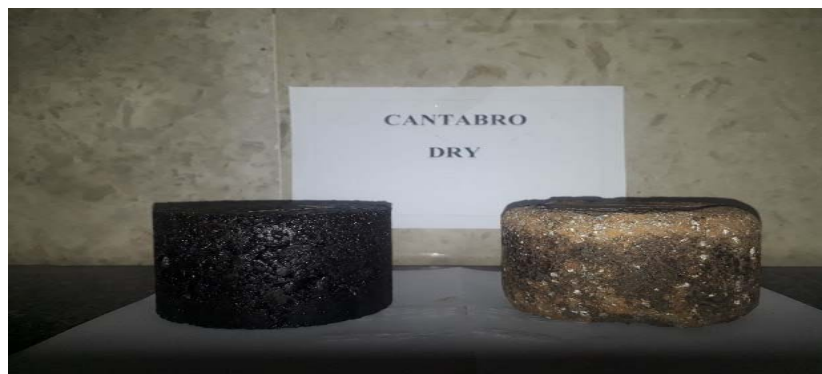
شکل ۲. دستگاه لس‌آنجلس و نمونه‌ها قبل و پس از انجام آزمایش کانتابرو
