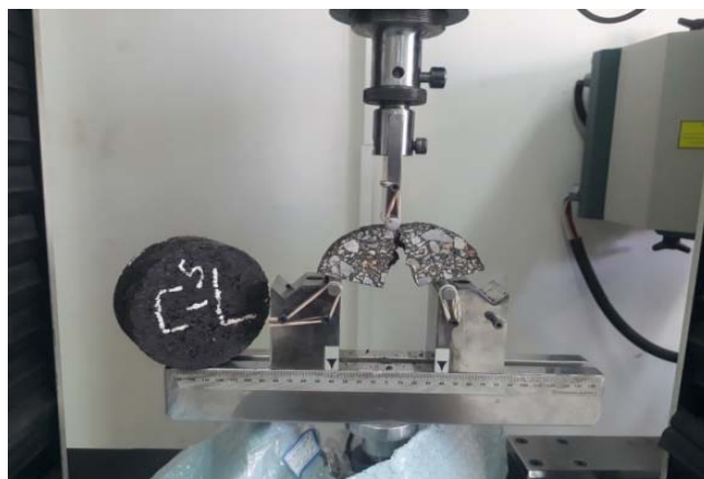
شکل ۳. آزمایش خمش نیم‌دایره
