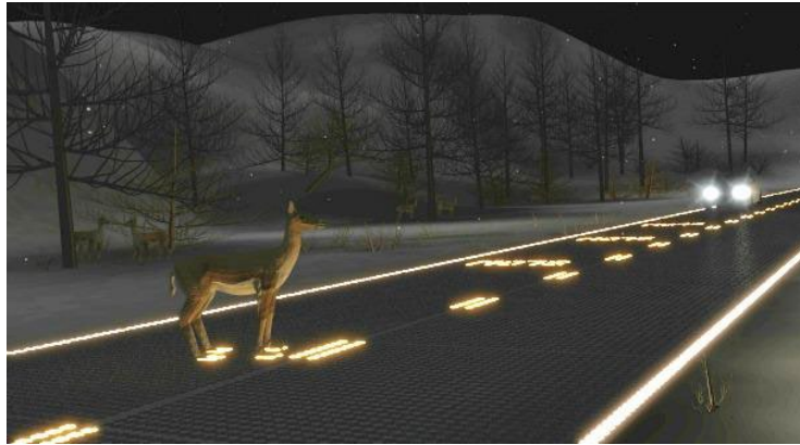
شکل ۷. نمونه‌ای از جاده خورشیدی مجهز به سیستم‌های روشنایی هوشمند، هشداردهنده و نشانگر خطر برای راننده‌ها (Renoald et al., 2016)
