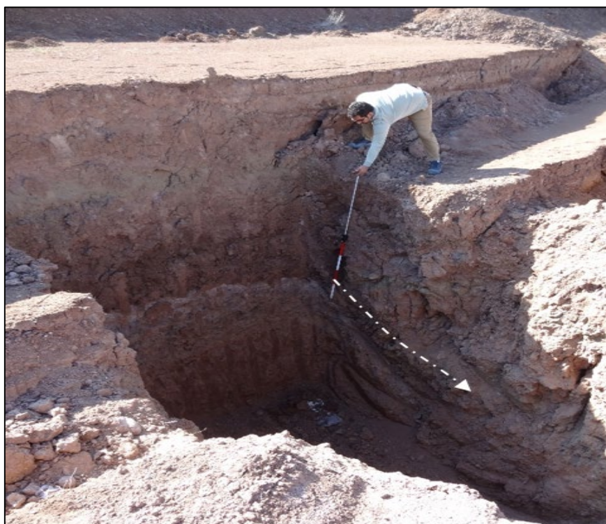
شکل ۵. مکانیزم جابجایی لایه‌ها در تاج رانش
