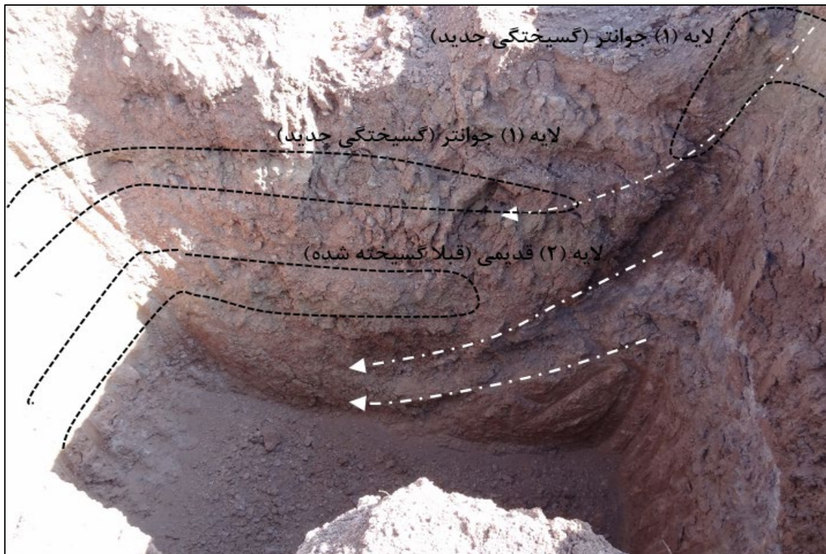
شکل ۶. روند کاهش جابجایی قائم لایه‌ها نسبت به عمق
