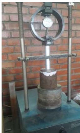
شکل ۱۱. نحوه انجام آزمون مقاومت فشاری تک محوری بر روی نمونه های مورد مطالعه.
