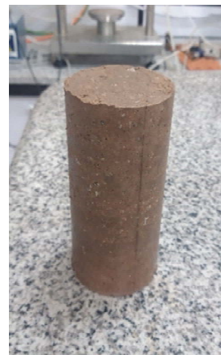
شکل ۲. مخلوط رس و ۲۰ درصد RCA تهیه شده جهت آزمایش RLT
