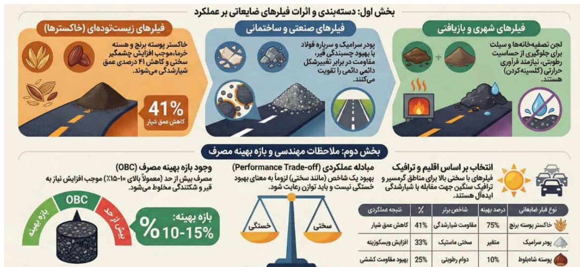
شکل ۱. دسته‌بندی فیلرهای ضایعاتی بر اساس منشأ و نمایش شماتیک اثرات آن‌ها بر شاخص‌های عملکردی مخلوط آسفالتی، شامل شیارشدگی، دوام رطوبتی، سختی و خستگی، به‌همراه مفهوم بازه بهینه مصرف و مبادله عملکرد
