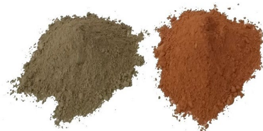
شکل ۱۵. سیلت اصلاح نشده (سمت چپ) و سیلت اصلاح شده با حرارت (شکل سمت راست) (Solouki et al., 2023)
