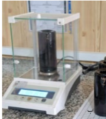
شکل ۲. آزمایشات-تجربی: الف-نقطه اشتعال ب-تغییر جرم ج-نمونه‌های آماده شده جهت آزمایش DSR
