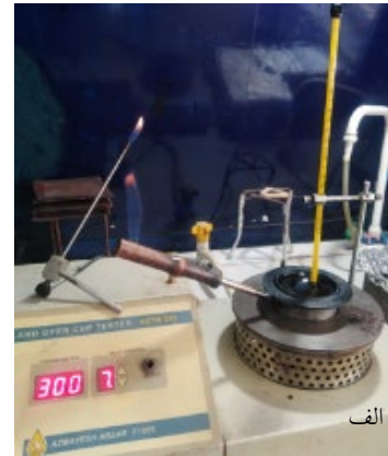
شکل ۲. آزمایشات-تجربی: الف-نقطه اشتعال ب-تغییر جرم ج-نمونه‌های آماده شده جهت آزمایش DSR
