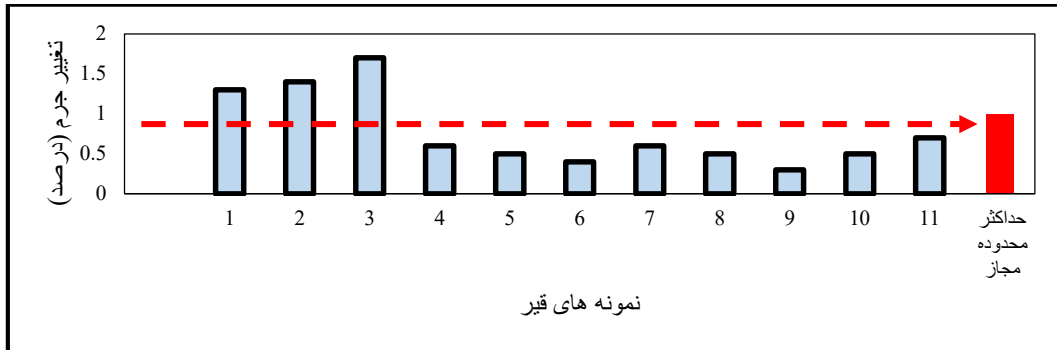
شکل ۴. نتایج آزمایش تغییر جرم نمونه های قیر
