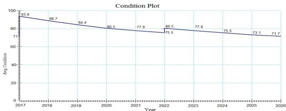
شکل ۱۴. وضعیت PCI قطعات با سناریوی بودجه نامحدود
