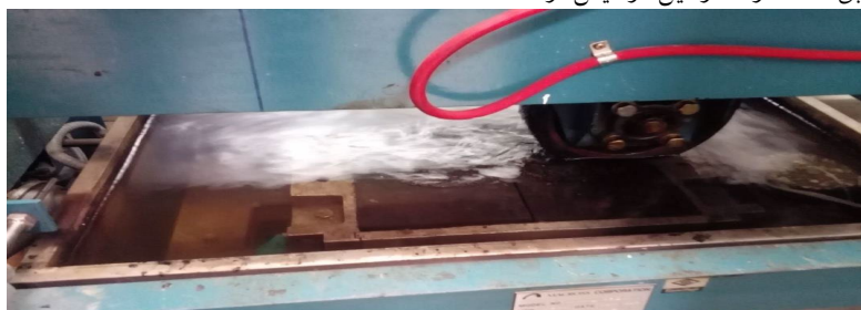
شکل ۴. انجام آزمایش شیار افتادگی با دستگاه ویل تراک
