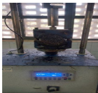
شکل ۲. نمونه‌های استوانه‌ای مارشال ساخته‌شده از مخلوط سرد سرباره‌ای در مراحل: الف) بلافاصله پس از تراکم، ب) در حین آزمون مارشال
