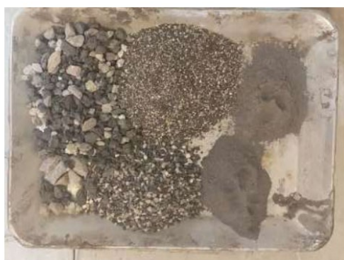
شکل ۱. نمایی از سنگدانه‌های سرباره‌ی کوره‌ی القایی پس از فرآوری، نمونه‌های آماده‌شده برای آزمون لوس آنجلس و دانه‌بندی تفکیک‌شده در آزمایشگاه
