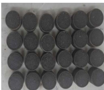
شکل ۲. نمونه‌های استوانه‌ای مارشال ساخته‌شده از مخلوط سرد سرباره‌ای در مراحل: الف) بلافاصله پس از تراکم، ب) در حین آزمون مارشال
