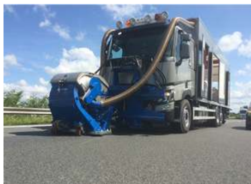
شکل ۷. ماشین احیا سازی رویه صیقل یافته به روش از طریق روش سند بلاست
