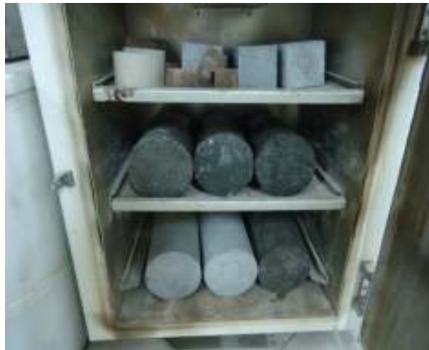
شکل ۳. نمونه‌های آزمایش جذب مویستگی در آون پیش از آزمایش
