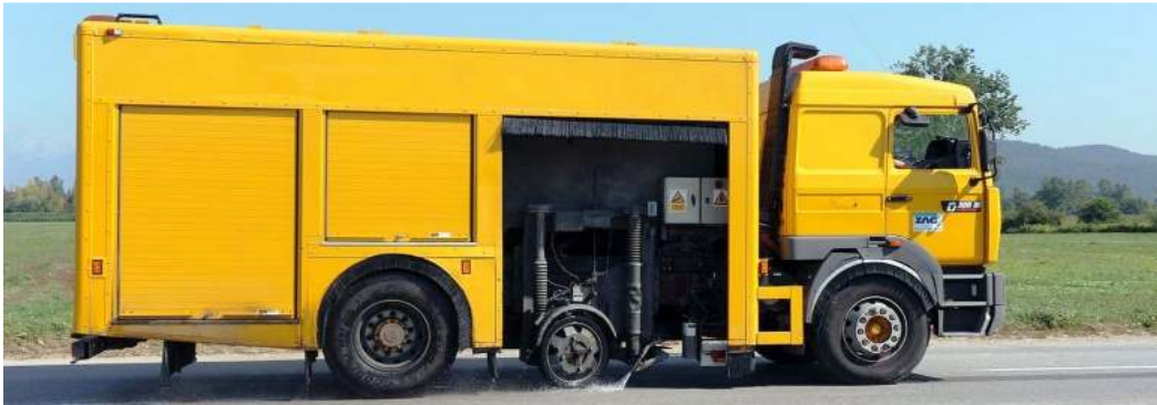
شکل ۳. دستگاه (SCRIM) قادر به اندازه‌گیری مداوم مقاومت لغزشی روسازی را نشان می‌دهد.
